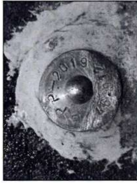
รูปที่ 2.3-3 ภาพถ่ายหมุดหลักฐานทางดิ่ง BPP-2019
